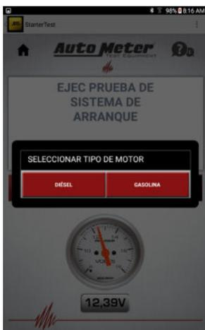
**Aviso:** Si se detecta corriente de arranque alta, esto podría ser el resultado de una carga más pesada encontrada en un motor diésel. Esta pantalla permite seleccionar un tipo de motor.
