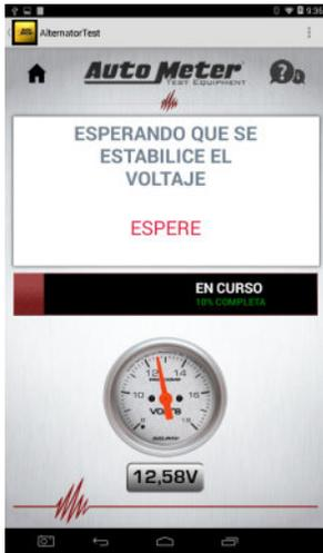
El BVA-460 esperará que se establezca el voltaje del sistema de los vehículos. Esto puede demorar hasta 30 segundos.
