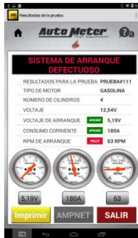
Si el probador detectó carreras de compresión en el motor durante el arranque, la pantalla de resultados mostrará las RPM de arranque del motor. Esta pantalla aparecerá si la velocidad de arranque del motor durante el arranque fue baja.
