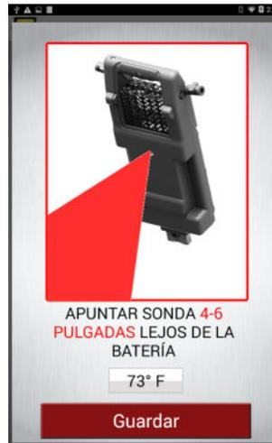
Al presionar el área Medir temperatura de batería. La pantalla de la sonda de temperatura se activa. Apunte la sonda a la batería desde una distancia de 4 a 6 pulgadas (10 a 15 centímetros). Presione guardar para almacenar la lectura de la temperatura y regresar a la pantalla de Prueba de batería.
