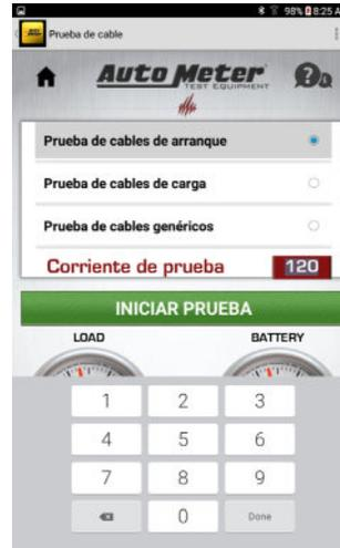
Para establecer la corriente de prueba, presione la casilla de corriente de prueba y aparecerá un teclado numérico. Introduzca el consumo de corriente del arrancador para el vehículo que está probando. Presione el botón Listo y después presione el botón Iniciar prueba.
