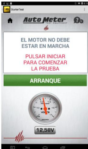
Al estar listo para realizar la prueba de arranque; para motores a gasolina, asegúrese de que la llave de encendido esté en la posición de apagado y que todos los accesorios estén apagados. Presione el botón de Arranque. Para motores diésel, apague todos los accesorios, gire la llave de encendido a la posición marcha y espere que las bujías de precalentamiento se enciendan y después se apaguen. Presione el botón de Arranque.
