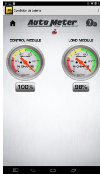
La pantalla de estado de batería muestra el estado de carga de las baterías en el módulo de control y en el módulo de carga.
