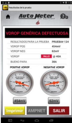
Si la caída de voltaje es alta, la prueba dará un resultado negativo. El cable defectuoso puede detectarse mirando los resultados de caídas positivo y negativo. En esta pantalla el cable positivo es el problema.
