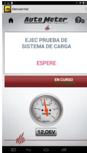
Una vez que el voltaje esté estable el BVA-460 probará el sistema de carga.
