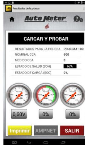
La batería no tuvo suficiente carga para realizar una prueba exacta. Recargue la batería y después pruébela.
