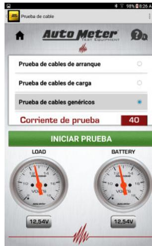
Para establecer la corriente de prueba, presione la casilla de corriente de prueba y aparecerá un teclado numérico. Introduzca la corriente de prueba para el circuito que está probando. Presione el botón Listo y después presione el botón Iniciar prueba.
