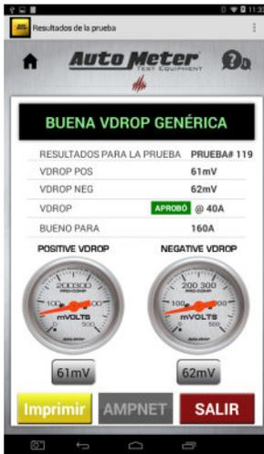
Si la caída de voltaje combinada de los circuitos positivo y negativo es menor de 500 mV, aprueba la prueba de caída de voltaje. Si la prueba de caída de voltaje falla, debe iniciar la solución de problemas y reparar el lado del circuito con la mayor caída de voltaje.
