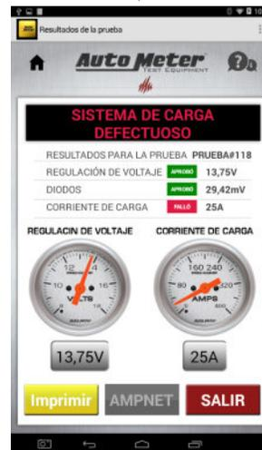
Si el sistema de carga falla por corriente de carga baja, vuelva a realizar la prueba manteniendo el motor a una velocidad ralenti más rápida. (1500-2000 RPM)
