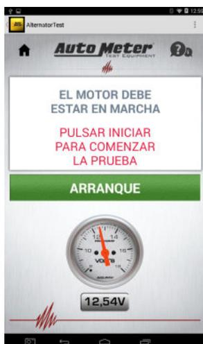
Asegúrese de que el módulo de carga esté conectado a la batería y que el motor esté en marcha. Presione el botón ARRANQUE para iniciar la prueba.
