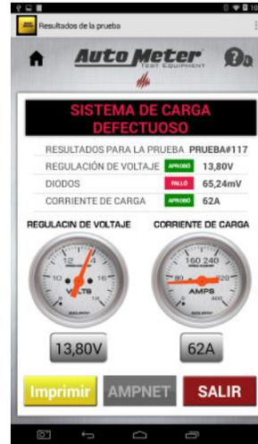
Esta pantalla aparecerá si el rizado de voltaje es alto lo cual es un indicador de una falla de diodos en el alternador.
