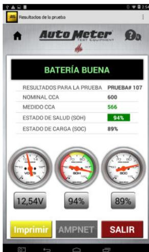
La batería aprobó la prueba y se puede volver a poner en servicio.
