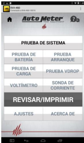
Desconecte el módulo de control del módulo de carga. Asegúrese de que el motor esté apagado. Conecte las pinzas grandes del módulo de carga a la batería. Coloque el módulo de carga en una ubicación estable en el compartimiento del motor de manera que no se caiga cuando el motor arranque. Lleve el módulo de control al interior del vehículo. Desde el menú principal presione el botón Prueba de arranque.
