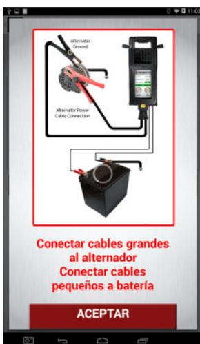
La pantalla le mostrará dónde hacer sus conexiones. Las pinzas grandes deben conectarse a los terminales del alternador. La pinza roja al terminal positivo del alternador, la negra a la tierra del alternador. Las pinzas pequeñas deben conectarse a los bornes de la batería. La pinza roja pequeña al borne positivo de la batería, la pinza negra pequeña al borne negativo de la batería.
