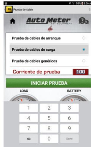
Para establecer la corriente de prueba, presione la casilla de corriente de prueba y aparecerá un teclado numérico. Introduzca la salida del alternador para el vehículo que está probando. Presione el botón Listo y después presione el botón Iniciar prueba.
