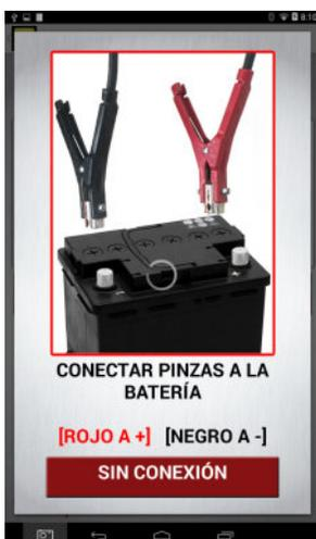
Si hay algún problema de conexiones, aparecerá la pantalla siguiente. Verifique sus conexiones a la batería y asegúrese de que los bornes estén libres de corrosión. Esta pantalla desaparecerá y la prueba continuará una vez que la conexión se haya corregido.
