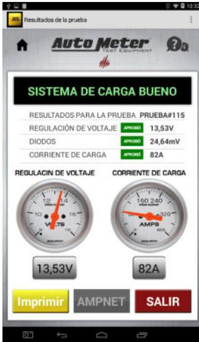
Esta pantalla aparecerá si el sistema de carga aprueba la prueba.
