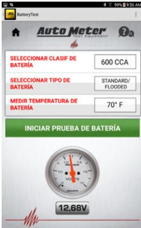
Aparecer la pantalla siguiente para ingresar valores para la clasificación, tipo y temperatura de la batería. Estos se pueden ingresar presionando el botón a la derecha del valor que desea cambiar. Presione Iniciar Prueba de batería cuando todos los datos sean correctos y usted esté listo para probar la batería.
