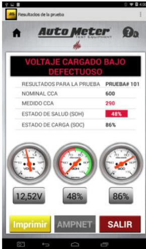
La batería no tuvo suficiente capacidad restante para aprobar la porción con carga de la prueba. Se recomienda sustituir la batería inmediatamente
