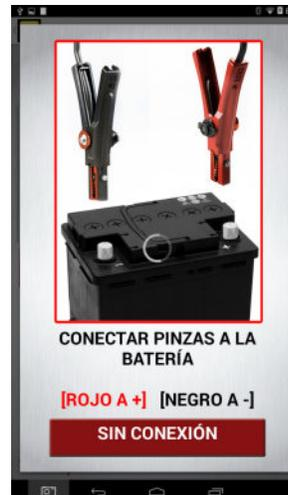
Si hay algún problema de conexiones aparecerá la pantalla siguiente. Verifique las conexiones y asegúrese de que los bornes de la batería y las pinzas estén libres de corrosión.
