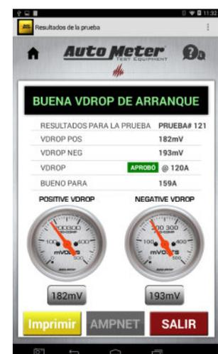
Si la caída de voltaje combinada de los circuitos positivo y negativo es menor de 500 mV, aprueba la prueba de caída de voltaje. Si la prueba de caída de voltaje falla, debe iniciar la solución de problemas y reparar el lado del circuito con la mayor caída de voltaje.
