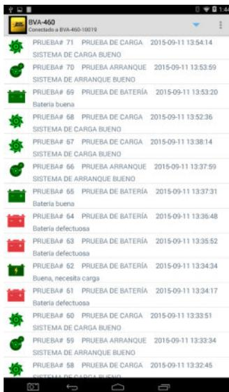
La pantalla Resultados de las pruebas muestra una lista de las pruebas que han sido realizadas y permite al usuario visualizar todos los detalles de la prueba.
