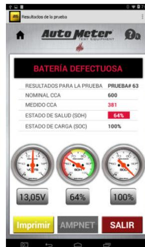
La batería no tuvo suficiente capacidad restante para aprobar la prueba. Se recomienda sustituir la batería inmediatamente.
