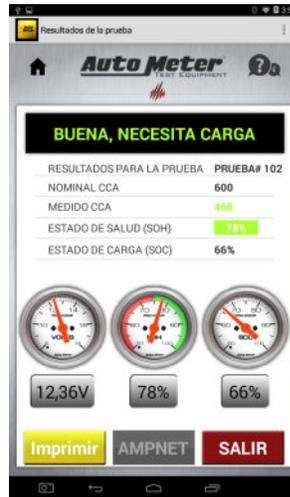
La batería aprobó la prueba pero tuvo un voltaje inicial bajo. Recargue la batería y después vuelva a ponerla en servicio.
