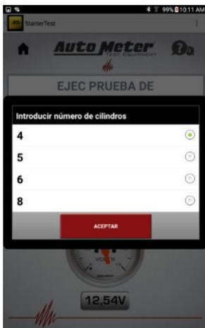
Si se detectaron carreras de compresión en el motor, el BVA-460 le preguntará cuántos cilindros tiene el motor a fin de poder calcular la velocidad de arranque del motor.
