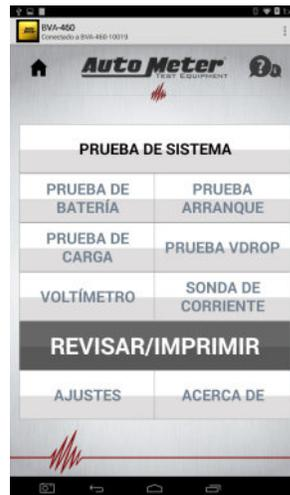
Para medir la corriente que pasa a través de un cable, presione el botón Sonda de corriente.
