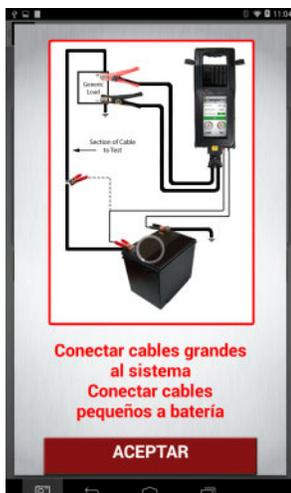
Si está realizando una prueba genérica, la pantalla le indicará que debe hacer sus conexiones. Las pinzas grandes deben conectarse al extremo de los cables que está probando. La pinza roja al extremo positivo y la negra a la conexión de tierra. Las pinzas pequeñas deben conectarse a los bornes de la batería. La pinza roja pequeña al borne positivo de la batería, la pinza negra pequeña al borne negativo de la batería.
