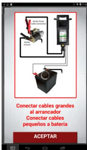
La pantalla le mostrará dónde hacer sus conexiones. Las pinzas grandes deben conectarse a los terminales del arrancador la pinza roja al terminal positivo del arrancador, la negra a la conexión de tierra del arrancador. Las pinzas pequeñas deben conectarse a los bornes de la batería. La pinza roja pequeña al borne + de la batería, la pinza negra pequeña al borne - de la batería.
